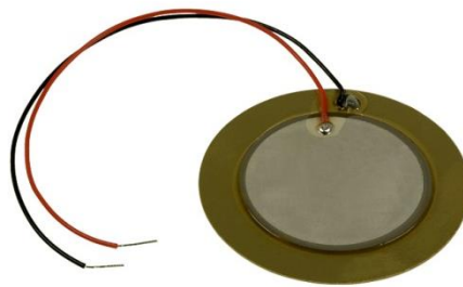
Figura 4.1: Disco de material piezelétrico e seus terminais.
